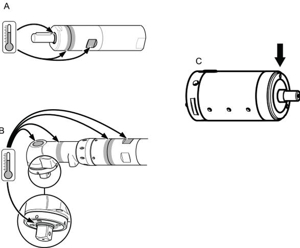
Motor yüksüz tam basınç altında çalışırken en yüksek sıcaklıklar meydana gelir. Artan tork ile birlikte, hava motoru dönüş hızını ve sıcaklığı azaltır.
