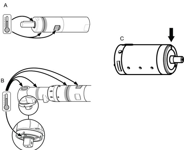
De høyeste temperaturene oppstår når motoren kjører ved fullt trykk uten belastning. Ved økende moment reduserer luftmotoren rotasjonshastigheten og temperaturen.
