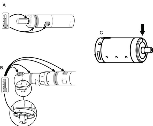
A motor maximális nyomás mellett, terhelés nélküli forgása esetén lépnek fel a maximális hőmérsékletek. A nyomaték növelésével csökken a légmotor fordulatszáma és a hőmérséklete.
