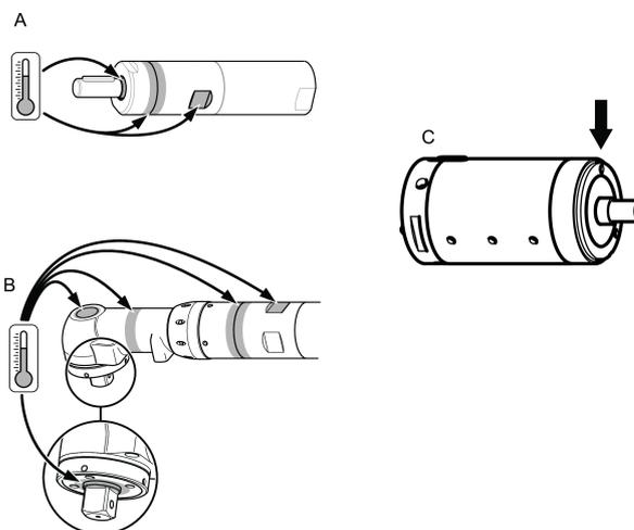
Najwyższe temperatury występują, gdy silnik działa przy maksymalnym ciśnieniu bez obciążenia. Wraz ze wzrostem momentu obrotowego silnik pneumatyczny obniża prędkość obrotową i temperaturę.
