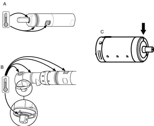
Najviša se temperatura pojavljuje kada motor radi pri punom tlaku bez opterećenja. S povećanim zakretnim momentom pneumatski motor smanjuje brzinu okretanja i temperaturu.
