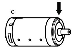
Οι υψηλότερες θερμοκρασίες σημειώνονται όταν ο κινητήρας λειτουργεί με πλήρη πίεση χωρίς φορτίο. Όσο αυξάνεται η ροπή, τόσο μειώνει ο αεροκινητήρας την ταχύτητα και τη θερμοκρασία περιστροφής.
