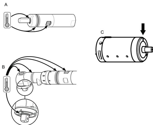
Augstākās temperatūras tiek sasniegtas, kad motors darbojas ar pilnu spiedienu bez slodzes. Palielinot griezes motoru, pneimatiskais motors samazina rotācijas apgriezienus un temperatūru.
