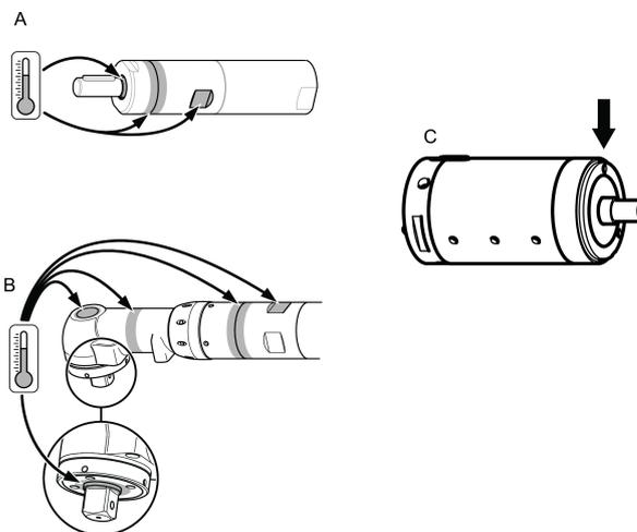
De hoogste temperatuur wordt bereikt wanneer de motor onbelast aan volle druk draait. Met toenemende koppel zal de luchtmotor de rotatiesnelheid en temperatuur verminderen.
