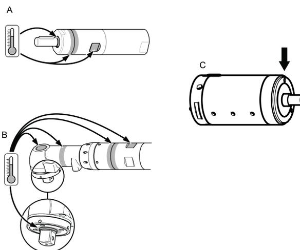
Les températures les plus élevées surviennent lorsque le moteur fonctionne à pleine pression à vide. Dès que le couple augmente, la vitesse de rotation du moteur pneumatique diminue, de même que la température.
