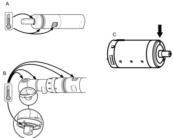
Die höchsten Temperaturen treten auf, wenn der Motor unbelastet bei vollem Druck läuft. Bei steigendem Drehmoment drosselt der Druckluftmotor die Drehgeschwindigkeit und damit die Temperatur.
