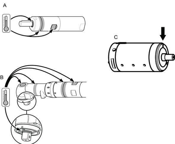
As temperaturas mais elevadas ocorrem quando o motor está operando a uma pressão total sem carga. Com o aumento do torque, o motor de ar reduz a velocidade de rotação e a temperatura.
