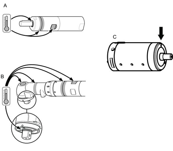
K nejvyšším teplotám dochází, pokud motor běží pod plným tlakem bez zátěže. Se zvyšujícím se momentem se snižují otáčky vzduchového motoru i jeho teplota.
