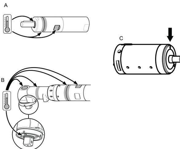
K najvyšším teplotám dochádza, keď je motor spustený pri plnom tlaku bez záťaže. S narastajúcim krútiacim momentom znižuje vzduchový motor rotačnú rýchlosť a teplotu.
