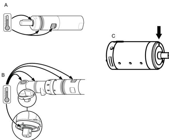
モータは無負荷の状態ですべてで作動しているときに最高気温になります。トルクが増加すると、空気モータは回転数と温度を低下させます。
