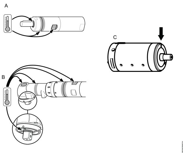
Temperaturile cele mai ridicate se înregistrează atunci când motorul funcționează la presiune maximă în gol. Simultan cu creșterea cupplului, motorul pneumatic reduce turația și temperatura.
