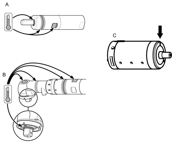
Las temperaturas más altas se producen cuando el motor funciona a máxima presión sin carga. Al aumentar el par, el motor de aire reduce la velocidad de rotación y la temperatura.
