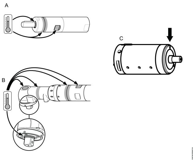
K najvyším teplotám dochádza, keď je motor spustený pri plnom tlaku bez záťaže. S narastajúcim krútiacim momentom znižuje vzduchový motor rotačnú rýchlosť a teplotu.
