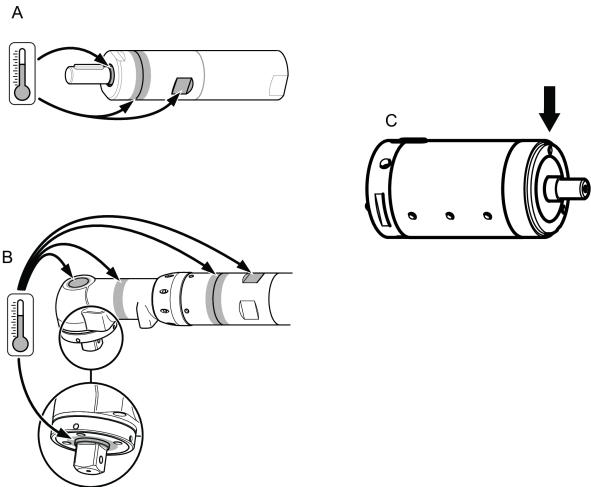
De højeste temperaturer opnås, når motoren kører ved fuldt tryk uden belastning. Ved stigende moment reducerer luftmotoren rotationshastigheden og temperaturen.
