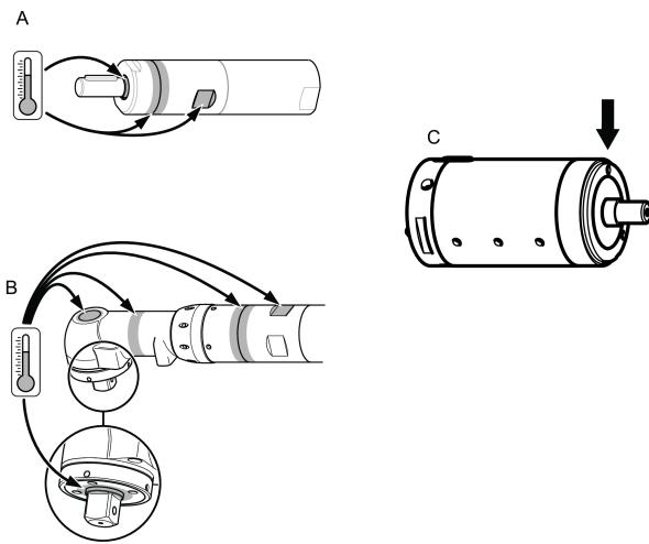
Do najvišjih temperatur pride, kadar motor deluje ob polnem tlaku brez obremenitve. S povečanjem navora se zmanjša vrtilna hitrost in temperatura zračnega motorja.
