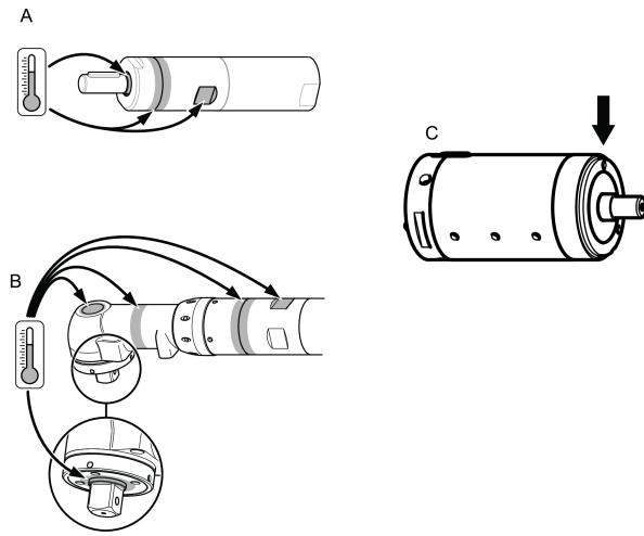
Самые высокие температуры возникают, когда двигатель работает при полном давлении без нагрузки. С увеличением крутящего момента уменьшается скорость вращения пневмодвигателя и температура.
