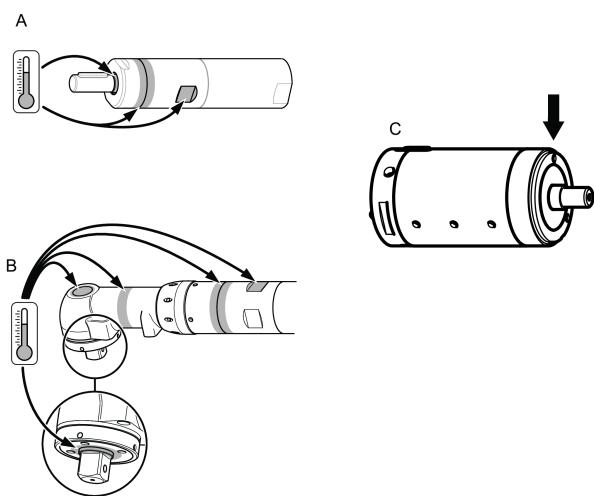
马达在全压空载运行时，温度将达到最高。随着扭矩的增大，气动马达的旋转速度和温度将会降低。
