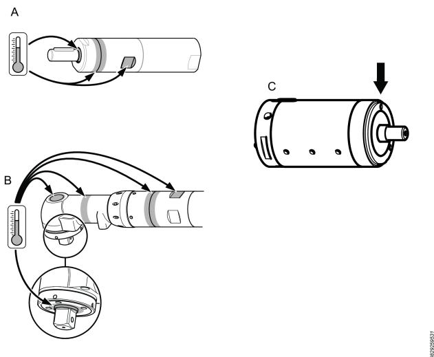
Temperaturile cele mai ridicate se înregistrează atunci când motorul funcționează la presiune maximă în gol. Simultan cu creșterea cuplului, motorul pneumatic reduce turația și temperatura.
