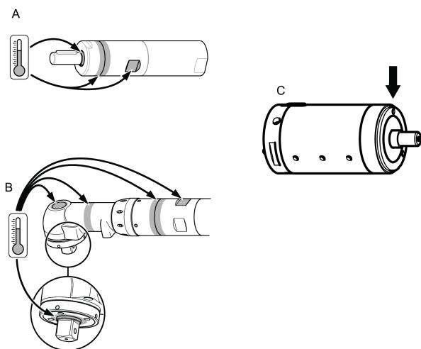
K nejvyšším teplotám dochází, pokud motor běží pod plným tlakem bez zátěže. Se zvýšujícím se momentem se snižují otáčky vzduchového motoru i jeho teplota.
