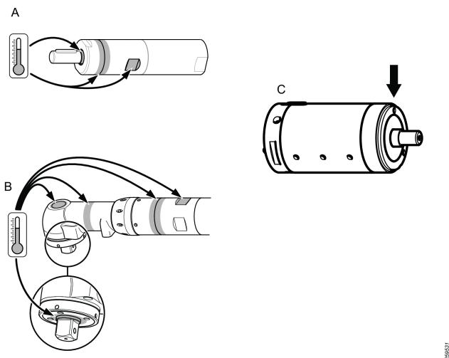
Οι υψηλότερες θερμοκρασίες σημειώνονται όταν ο κινητήρας λειτουργεί με πλήρη πίεση χωρίς φορτίο. Όσο αυξάνεται η ροπή, τόσο μειώνει ο αεροκινητήρας την ταχύτητα και τη θερμοκρασία περιστροφής.
