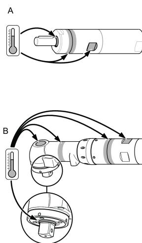
De hoogste temperatuur wordt bereikt wanneer de motor onbelast aan volle druk draait. Met toenemende koppel zal de luchtmotor de rotatiesnelheid en temperatuur verminderen.
