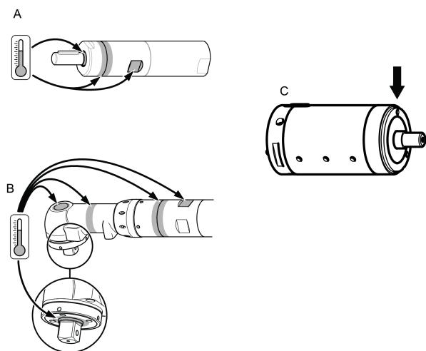
モータは無負荷の状態で全圧で作動しているときに最高気温になります。トルクが増加すると、空気モータは回転数と温度を低下させます。
