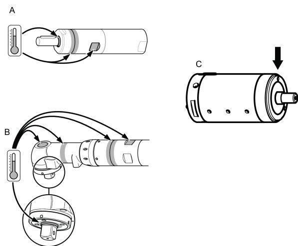
Korkeimmat lämpötilat syntyvät, kun moottori käy täydellä paineella ilman kuormaa. Lisäämällä vääntöä, rajoittaa ilmamoottori pyörimisnopeutta ja lämpötilaa.
