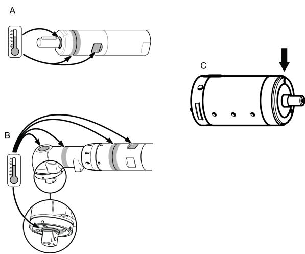
Si verificano le temperature più elevate quando il motore funziona a piena pressione e senza carico. Con l'aumento della coppia, il motore pneumatico riduce la velocità di rotazione e la temperatura.
